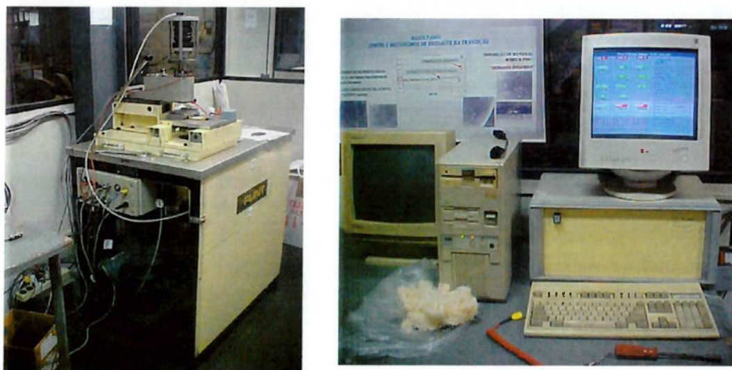
Figura 5: A primeira figura mostra o equipamento PLINT & PARTNERS e a segunda o computador e a controladora (Abaixo do monitor).
