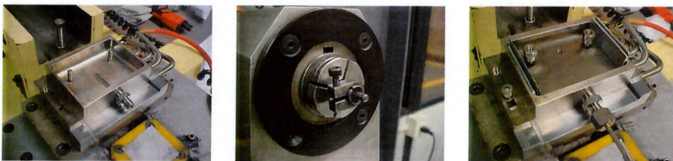
Figura 6: A primeira mostra o suporte da placa, a segunda o suporte para o pino e a terceira a placa a ser testada montada no suporte. As chapinhas laterais são para evitar o transbordamento de óleo.
